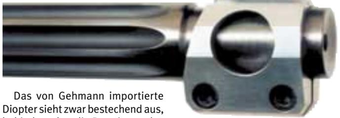
Das von Gehmann importierte Diopter sieht zwar bestechend aus, behindert aber die Betätigung des Schlosses. Das Repetieren gelingt nur mit Visierlinienerhöhung, und selbst so angehoben schrammt der Finger noch regelmäßig an der horizontalen Verstellerschraube entlang.
